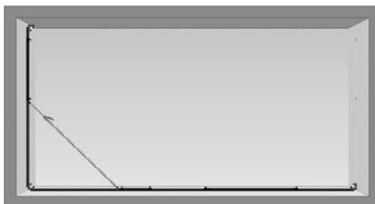
Pour une fixation et un réglage précis de la longueur des supports télescopiques, actionner ensuite à plusieurs reprises la poignée de serrage jusqu'à ce que les plateaux d'appui ou les vis de fixation des profilés soient arrêtés par les bords des transitions des profilés T aux profilés U ou au niveau des pieds d'appui des supports montés verticalement. Exercez uniquement la pression nécessaire pour garantir l'étanchéité des éléments muraux.
