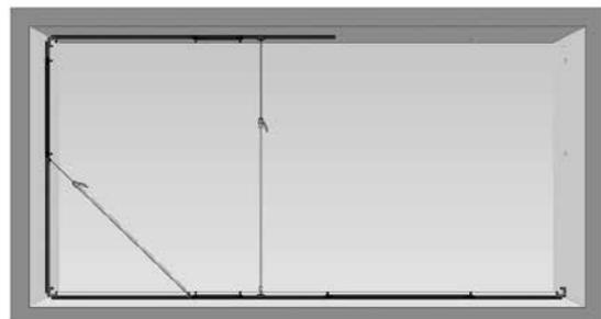
Anschließend stabilisieren Sie dieses freischwebende Teilstück mittels Teleskopstütze, die Sie zwischen der Decken- und der Bodenkonstruktion platzieren und ausfahren.
