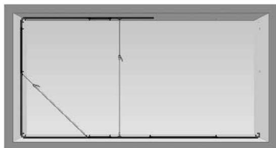
Dopo aver montato la prima parte, inserire in questa quanto più possibile gli elementi profilati della parte centrale della struttura per il soffitto.
