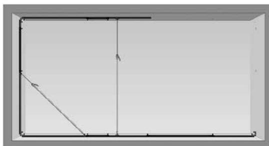
Stabiliser ensuite cette section flottante au moyen du support télescopique que vous placez et déployez entre la construction du plafond et la construction du sol.
