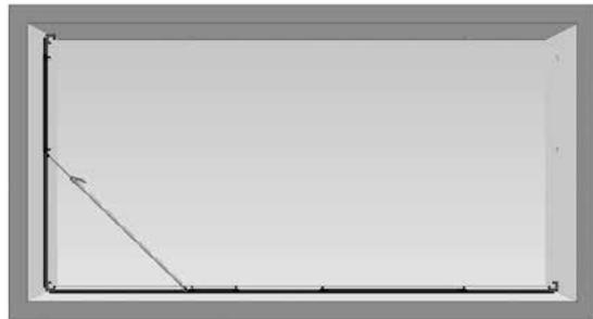
Voor het vastzetten en de exacte instelling van de lengte van de telescoopsteunen drukt u meerdere keren op de klemgreep tot de ondersteuningsschijven door de bevestigingsschroeven van de profielen, de kanten van de overgang van T- naar de U-profielen of op de steunvoet van de verticaal gemonteerde steunen worden gestopt. Gebruik niet meer druk dan noodzakelijk is om de dichtheid van de muurelementen te garanderen.
