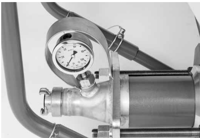
Manometro per la pressione della malta
